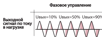
Диаграмма срабатывания ТТР KIPPRIBOR с фазовым управлением.
