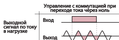
Диаграмма срабатывания ТТР KIPPRIBOR с контролем перехода через ноль.
