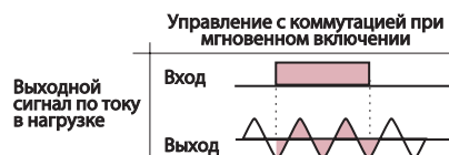
Диаграмма срабатывания ТТР мгновенного включения.
