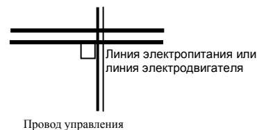
Рис. 3-14 Требования к прокладке проводов
