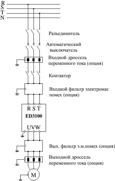
Рис. 3-4 Подключение преобразователя и дополнительного оборудования
