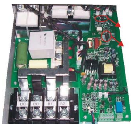
Джампер MASTER/SLAVE Джампер установки входного напряжения
