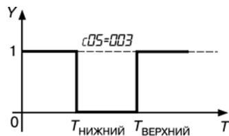
Рис. 3.17. Компаратор срабатывает вне установленных пределов
