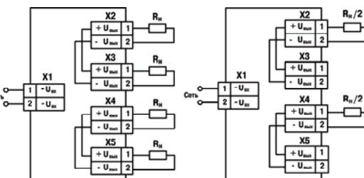
**Примечание.** При длине проводов между блоком и нагрузкой более 1м, рекомендуется параллельно нагрузке подключить керамический конденсатор емкостью не менее 0,1мКФ.
