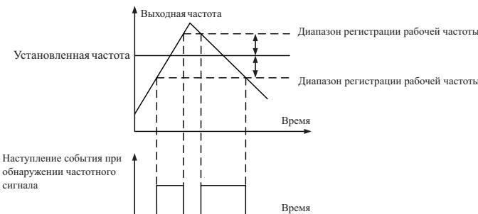
Абсолютный диапазон регистрации рабочей частоты = Обнаружение рабочей частоты в диапазоне регистрации (P2.2.02) x Максимальная частота (P0.0.07)
