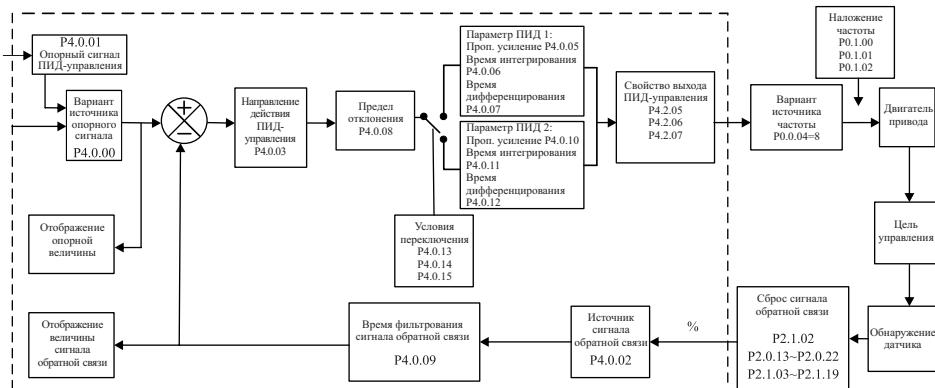
В состав преобразователя частоты входят два одинаковых блока расчетов ПИД-управления, рабочие параметры можно устанавливать раздельно, чтобы реализовать оптимальное использование скорости и точности регулировки. Переключения между блоками возможны по сигналам на многофункциональных клеммах, или по заданным отклонениям.
