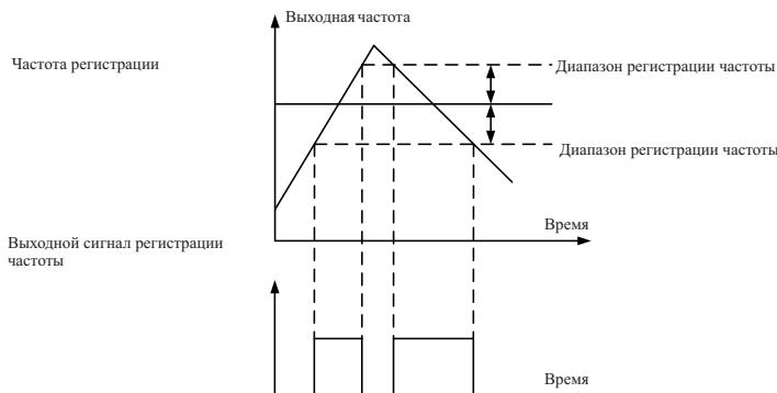
Фактический диапазон регистрации частоты = Диапазон регистрации частоты 1 (P2.2.08) X Максимальная частота (P0.0.07)
