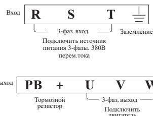
**Схема подключения сети питания Модели 3 серии MCI**
