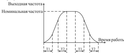
T1 - значение, установленное функциональным кодом P0.1.20, уклон выходной частоты постепенно увеличивается от нуля в пределах этого периода времени.
