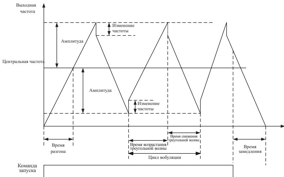
Примечание: выходная частота вобуляции находится в пределах, определяемых верхней и нижней частотой.
