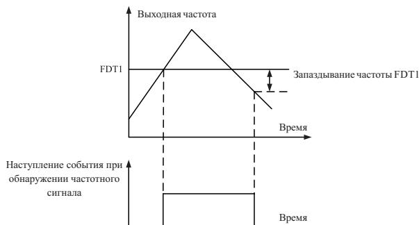
Значение запаздывания частоты FDT1 = Частота регистрации FDT1 (P2.2.03) X Запаздывание FDT1.
