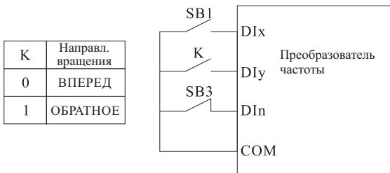
SB 1 - это нормально разомкнутая кнопка вращения вперед, кнопка SB3 - нормально замкнутая кнопка останова, кнопка K - кнопка выбора направления вращения.
