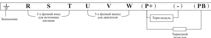
**Схема подключения сети питания Модели 4 серии FCI**
