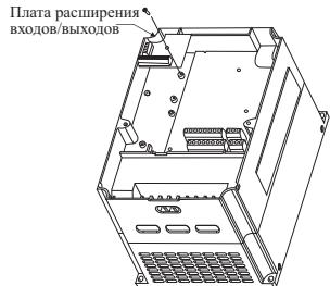
Способ установки платы расширения входов/выходов
