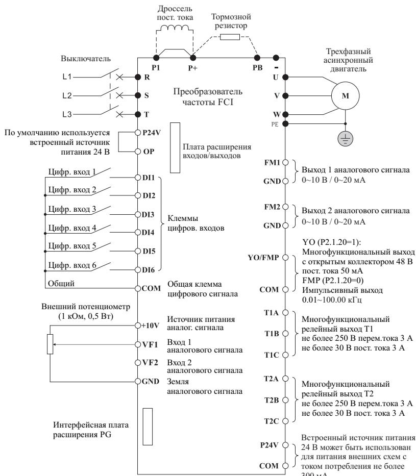
Стандартная конфигурация для преобразователей частоты мощностью 18,5 кВт и выше
