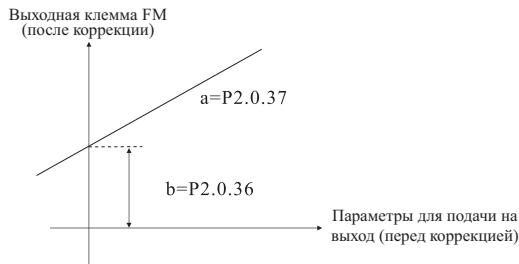
Корректированный выходной сигнал  $Y = aX + b$  ("X" означает рабочие параметры для подачи на вход, "a" - усиление выходного сигнала, а "b" - сдвиг выходного сигнала).
