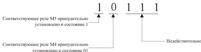
В соответствии с примером, приведенным выше, в случае настройки Р3.2.03 (управляющее слово В реле M2)=01022, из описания функционального кода Р3.2.03 можно узнать, что состояние реле M2=DI2 ИИ DI3, как показано на следующем рисунке:
