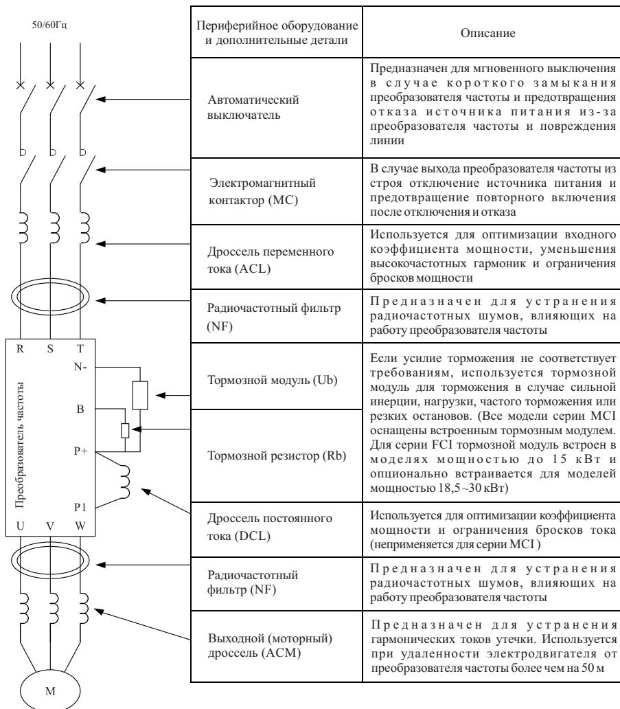
**3.3 Подключение сети питания****3.3.1 Схема подключения сети питания и меры предосторожности**
