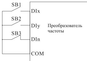
SB1 - нормально разомкнутая кнопка вращения вперед, SB2 - нормально разомкнутая кнопка обратного вращения, SB3 - нормально замкнутая кнопка останова.
