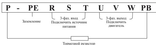
**Схема подключения сети питания Модели 1, 2 серии FCI**
