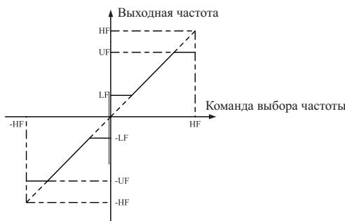
HF: Максимальная частота UF: Верхняя предельная частота LF: Нижняя предельная частота
