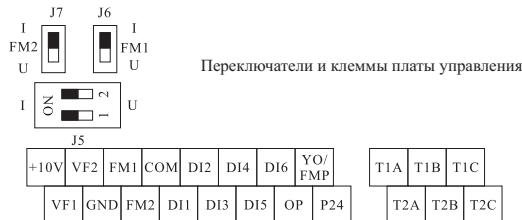
Стандартная конфигурация для преобразователей частоты мощностью 15 кВт и ниже
