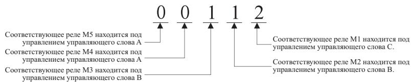
В соответствии с приведенным выше примером в случае установки кода P3.2.01 (управляющее слово А промежуточного реле задержки)=10111, реле M5 и M4 принудительно устанавливаются в состояниях: M5=1 и M4=0. Состояние реле M3, M2 и M1 не определяется управляющим словом А, т.о., настройка кода P3.2.01 для реле M3, M2 и M1 становится недействительной.
