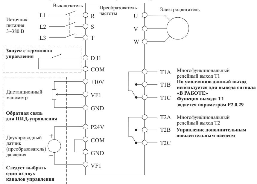
Замечание: Если используется дистанционный манометр, переключатель J5-1 (DIP переключатель входной клеммы VF1) должен находиться в положении U, если применяется датчик давления, переключатель J5-1 должен находиться в положении I.
