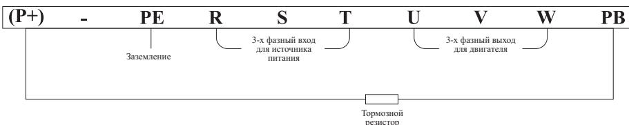
**Схема подключения сети питания Модели 3 серии FCI**
