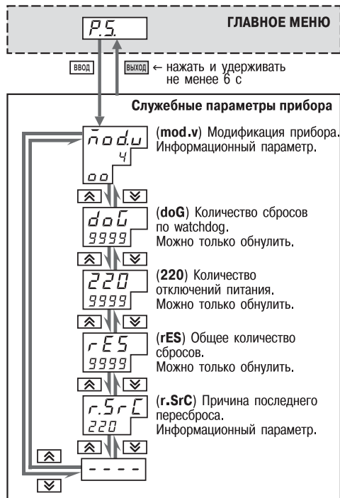
Рис. 45. Схема доступа к служебным параметрам прибора
