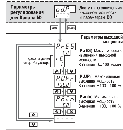
Рис. 40. Схема задания основных параметров конфигурации (продолжение). Задание ограничений выходной мощности
