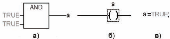
Рис. 5. Примеры программ на языках FBD (а), LD (б) и ST (в)
