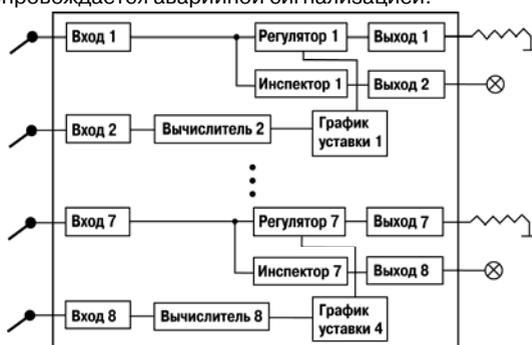
Рис. 3.5. Принципиальная схема модификации 5 прибора
