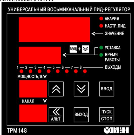
Рис. 5.1. Лицевая панель прибора
