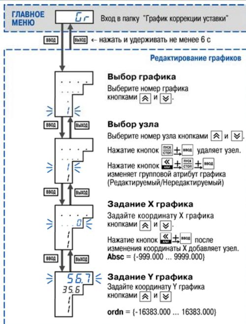
Рис. 9.24. Задание и редактирование графика коррекции уставки
