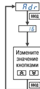
Рис. 9.5. Схема изменения значения параметра
