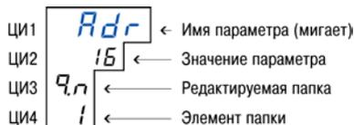
Рис. 9.3. Показания цифровых индикаторов при задании параметров
