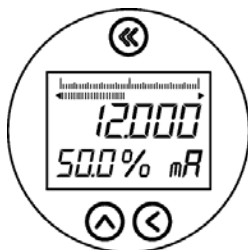
Рисунок 3.3 – Лицевая панель вычислительного блока
