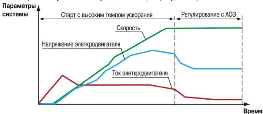
Рисунок 4.2 - Принцип работы оптимизации энергопотребления
