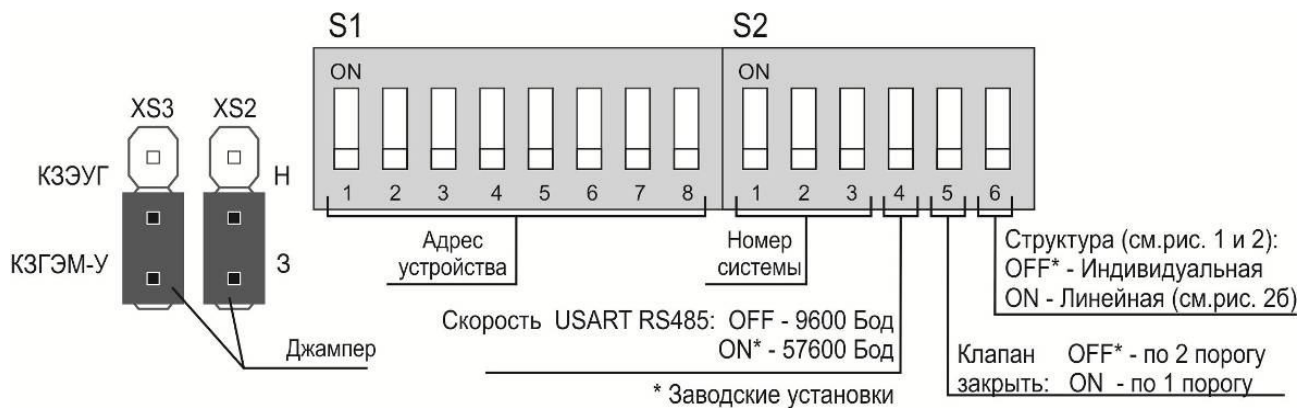
Рисунок 4 – Назначение переключателей и перемычек.
