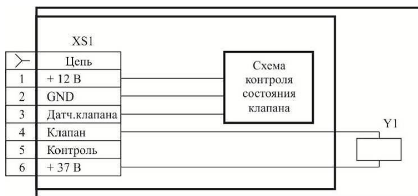
Рисунок 9 – Клапан КЗГЭМ-У. Схема электрическая принципиальная.
