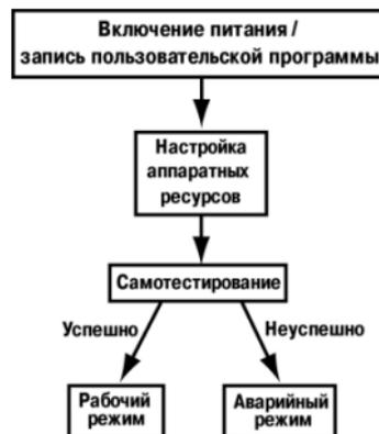
Рисунок 4.2 – Алгоритм запуска прибора
