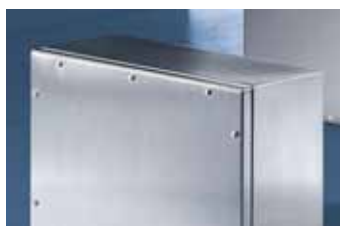
Premium Line KL Выдерживают мойку под высоким давлением, имеют IP 69K и высокое ЭМС экранирование, эти свойства обеспечиваются герметичностью системы и металлическим контактом между корпусом и задней стенкой.
