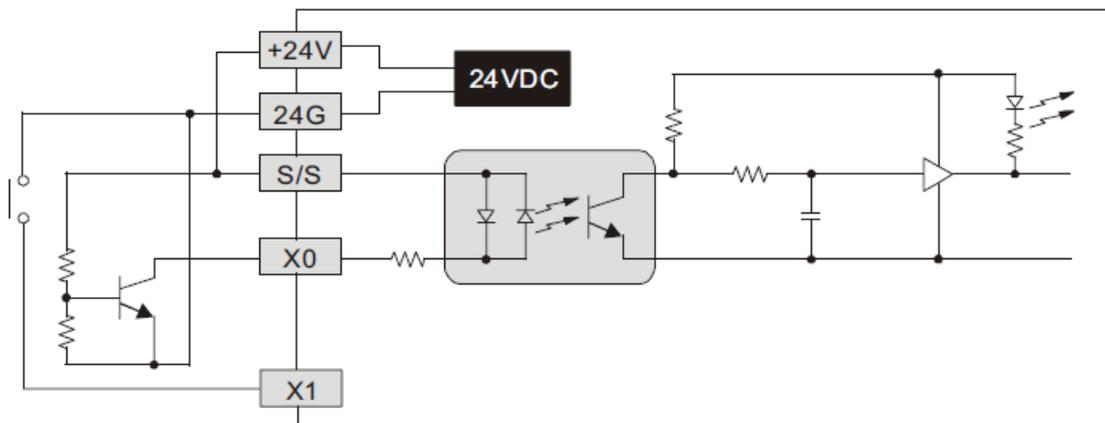
Эквивалентная схема подключения по PNP логике (Исток):
