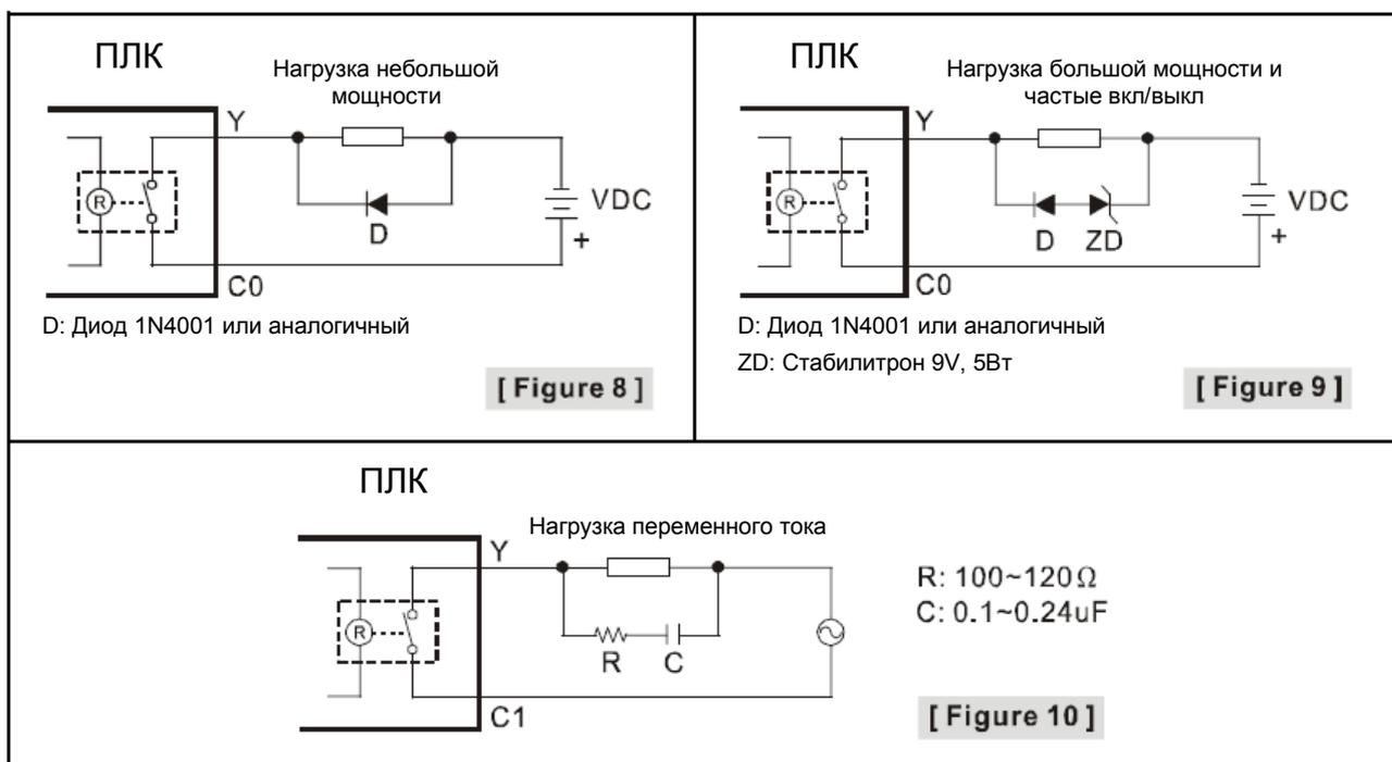
Схема подключения транзисторных выходов:
