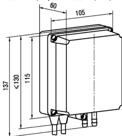
Рисунок А.1 – Преобразователь настенного крепления
