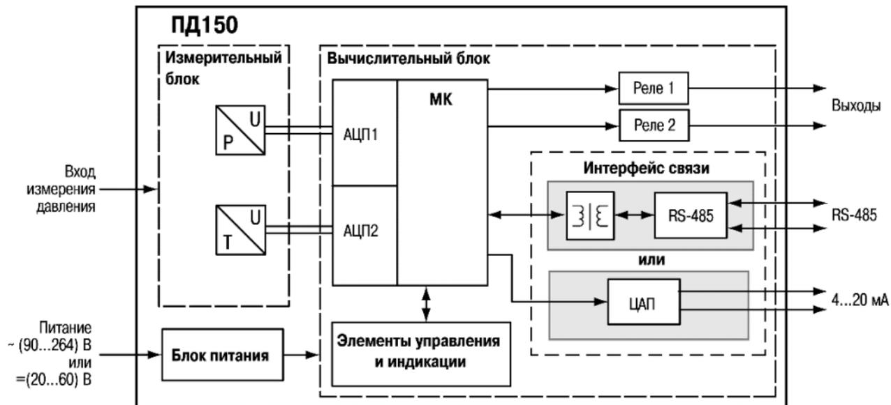
Рисунок 4.1 – Структурная схема преобразователя
