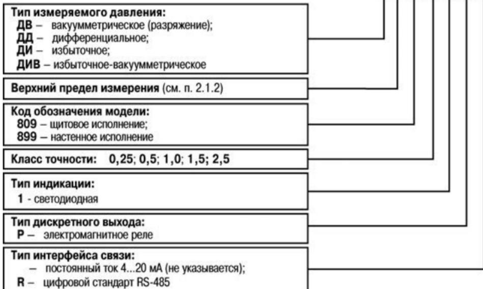
Пример записи полного обозначения преобразователя:
