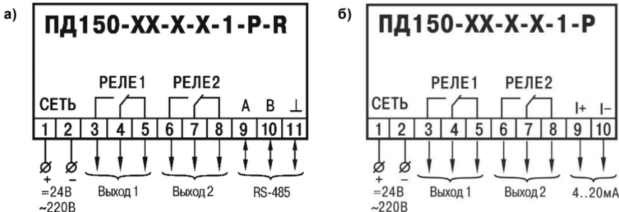
Рисунок Б.1 – Схема назначения контактов преобразователя:
