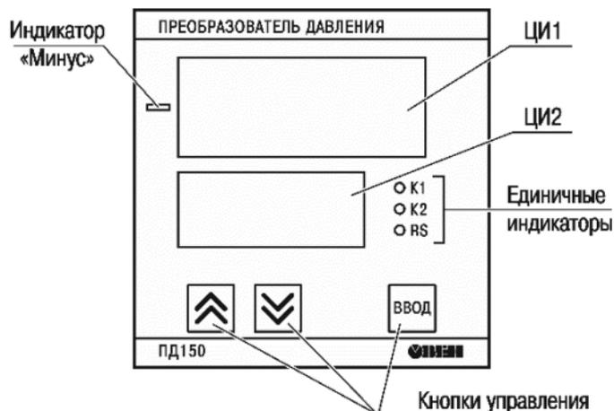
**Рисунок 4.3 – Внешний вид лицевой панели преобразователя**
