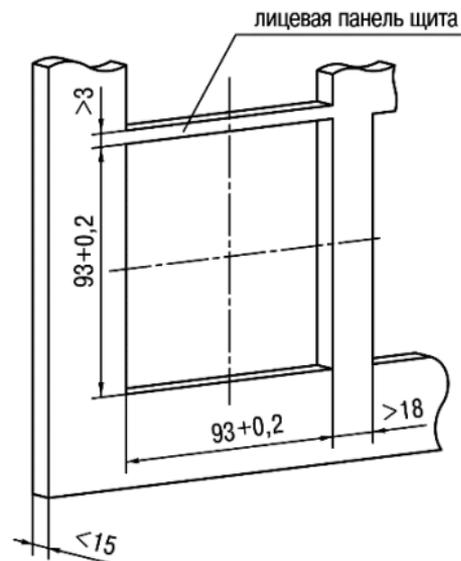
Рисунок А.2 – Преобразователь щитового крепления
